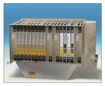
Figure 3. Boeing 787 CCR Cabinet<sup>17</sup>
