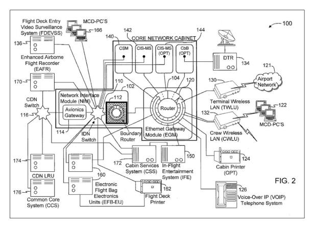
Figure 7. CIS Architecture <sup>19</sup>
